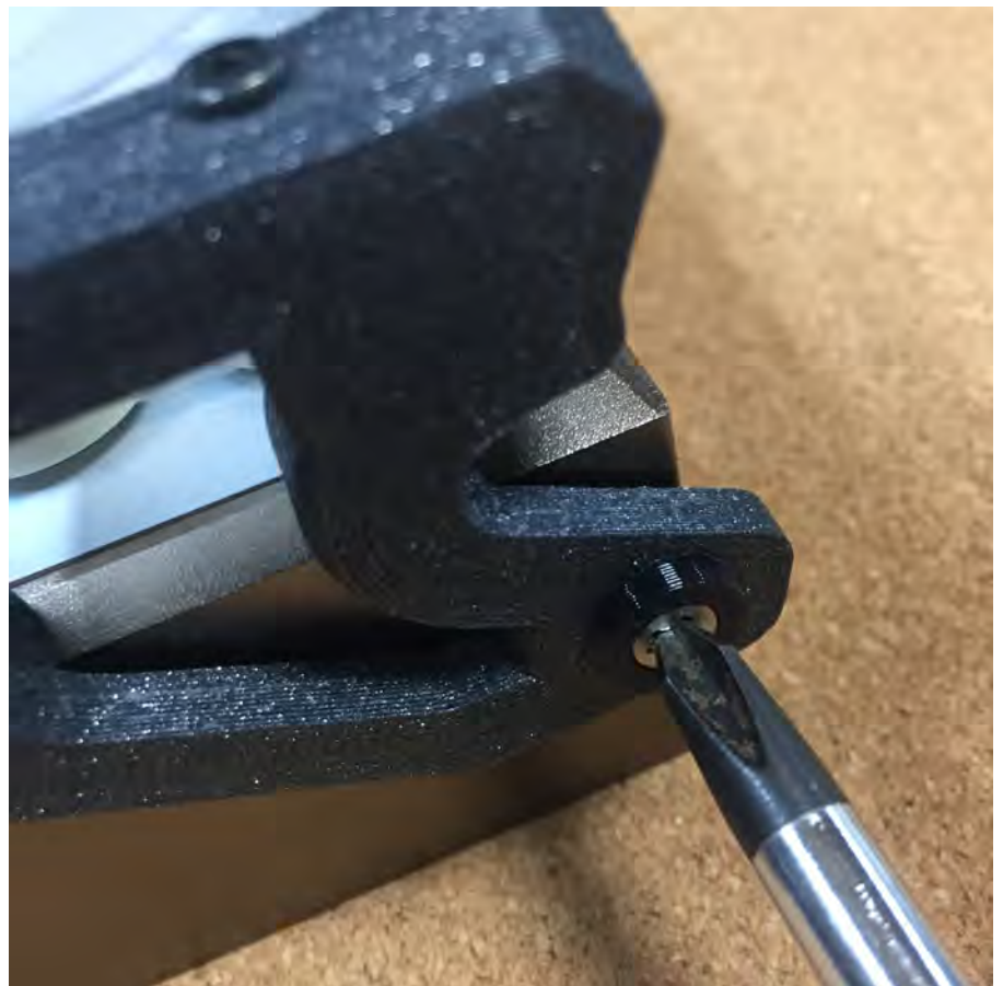
⑥ 締め具合の目安は、黒いナイロンワッシャーのフチから少し奥にめり込むくらいです。緩すぎるとノブガードの動きと連動してネジが回ってしまい、きつ過ぎると動くが重くなります。
