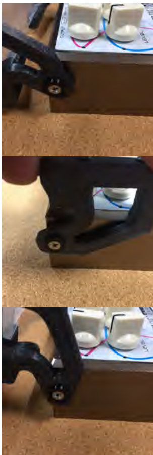
⑦ フェンスを動かし、ネジの+が回転しないか動きが重すぎないか確認します 必要に応じて締め具合を調整します
